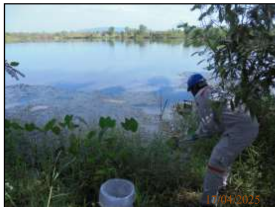
ภาพที่ 3.19 การตรวจวัดคุณภาพน้ำบ่อดักตะกอน จากหน้าเหมือง (บ่อ 2)
